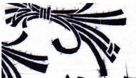
いわゆる「ヒゲ」という現象、染料が防染糊の隙間に入り込む
